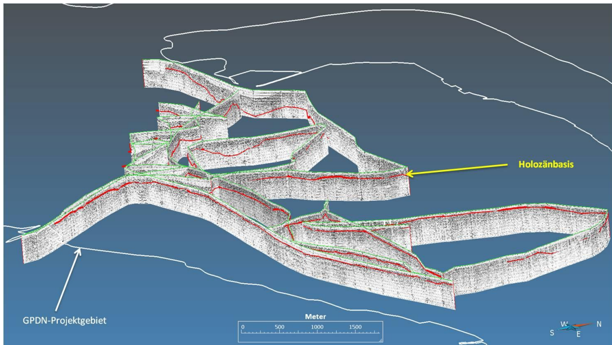
Abb.7: E-W-Ansicht Flachseismik Langeoog mit eingezeichneter Holozänbasis (Überhöhung 1:10, GOCAD®, Flachseismik nach BUNGENSTOCK (2005)).
